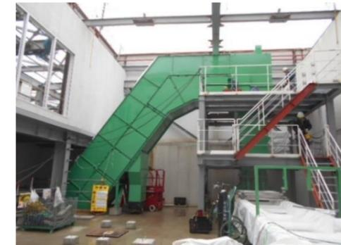
写真⑥ プラスチック製容器包装供給コンベヤ
